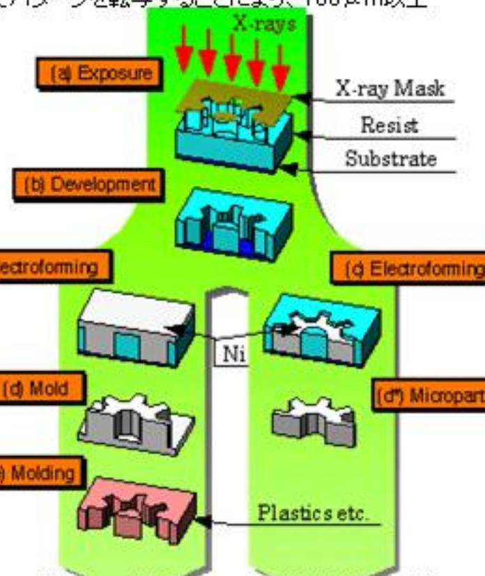
Fig.1 LIGAプロセスの基本工程図
