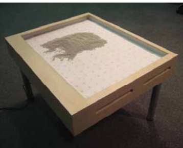
電磁石と小粒スチールボールを使用した触圧覚ディスプレイ制作
