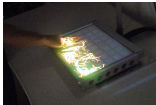
Fig.2 冷温視触覚ディスプレイ「Thermoesthesia」
