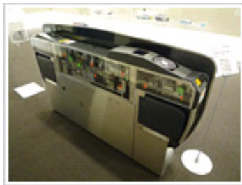
Fig. 3 切符の動きが見える自動改札機 ( http://www.omron.co.jp/about/ より)
