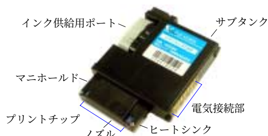
図2. 1 インチ・インラインプリントヘッド
