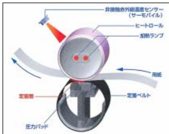
図 5 第二世代 FBNF 概略断面図
