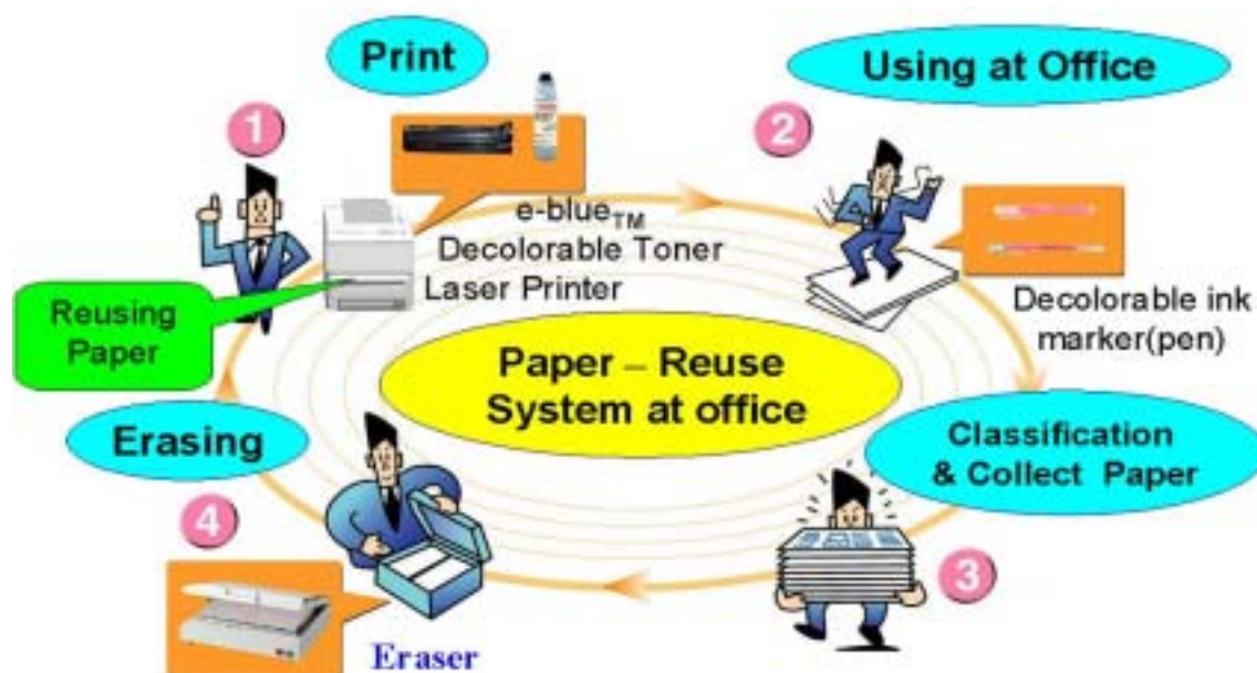
図5 , 消去可能トナーを用いたオフィス内紙リユースシステム
