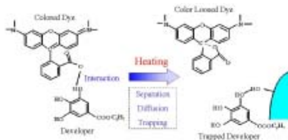
図 4 , 消去可能トナーの消去原理
