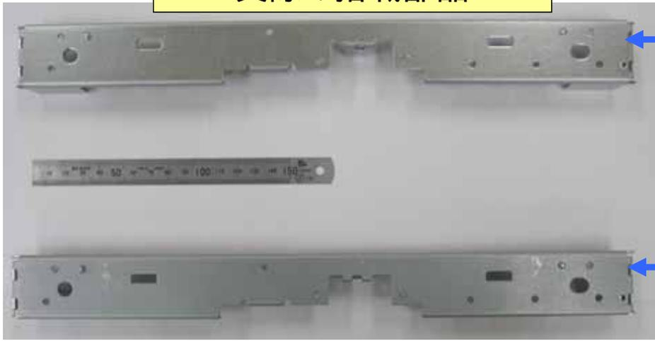
**電炉鋼板部品**
