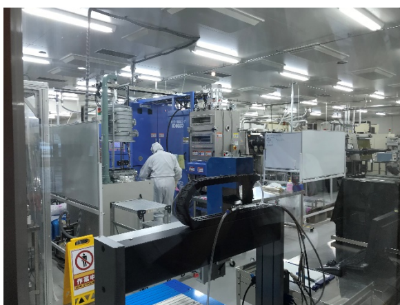
Fig.2 クラス 10,000 クリーンルーム内の様子
