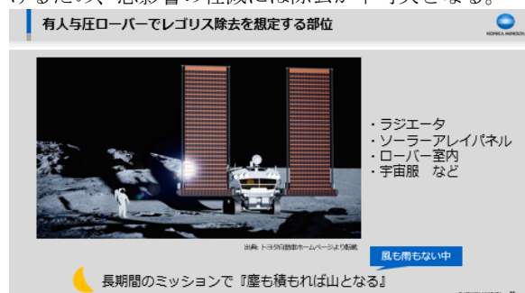
Fig. 3 レゴリス除去を想定する部位のイメージ図
